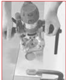
5. Maquinar furações. Drill holes.
