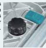
Pode-se regular a dureza do deslizamento sobre a guia e apertar a máquina a esta, para evitar quedas quando se corta a 45°.
