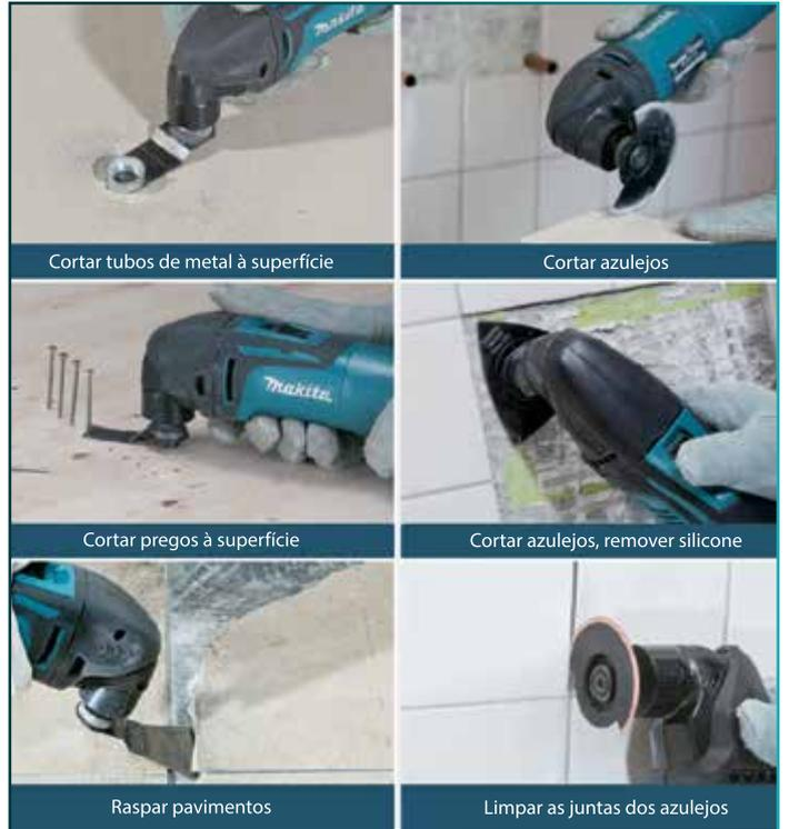
Cortar tubos de metal à superfície
